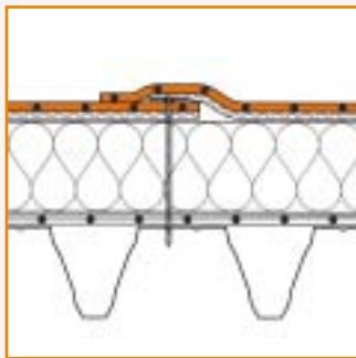
COVERIT-NOVOtan k mit mechanischer Befestigung, Tragekonstruktion Stahltrapezprofil
